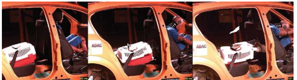
Crash-test avec cage en plastique sur le siège arrière ancrée avec la ceinture de sécurité - mannequin-chat.
