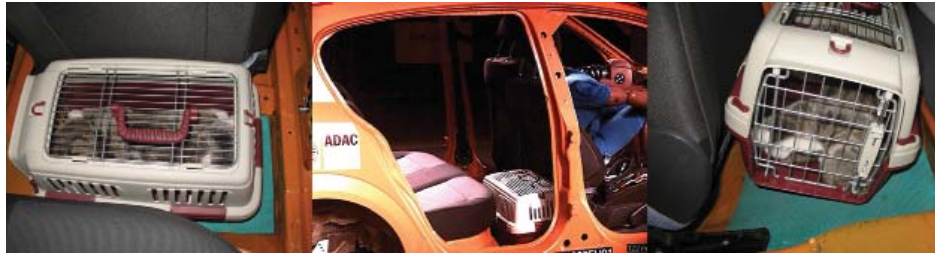
Crash-test avec cage en plastique dans l'espace pour les jambes derrière le siège avant - mannequin-chat.
